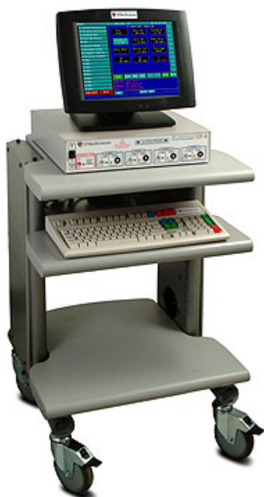
10 pav. Programuojamas, kompiuterinis elektrokardiostimulatorius "EP-4, EPMedSystems" . Jo valdymas galimas, tiek su klaviatūra, tiek priličiant ikonas monitoriuje.
